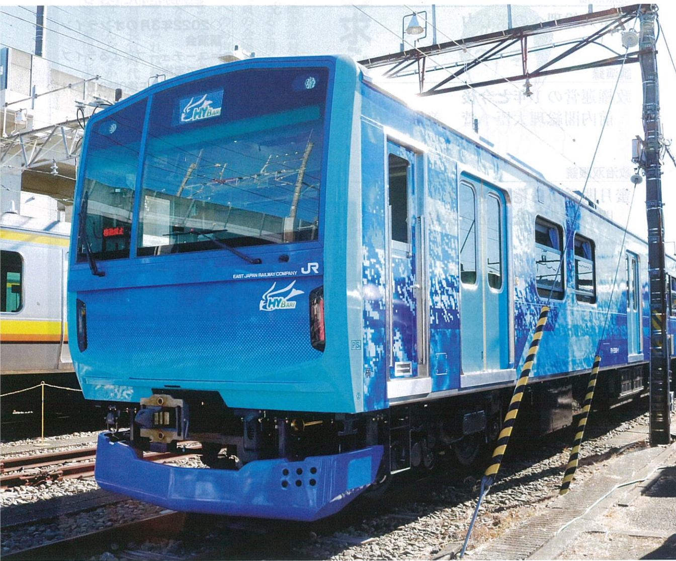
JR東日本は2月18日、水素を燃料とする燃料電池と蓄電池で走る電車「HYBARI（ひばり）」を公開した。南武線などで走行試験を行う予定。
