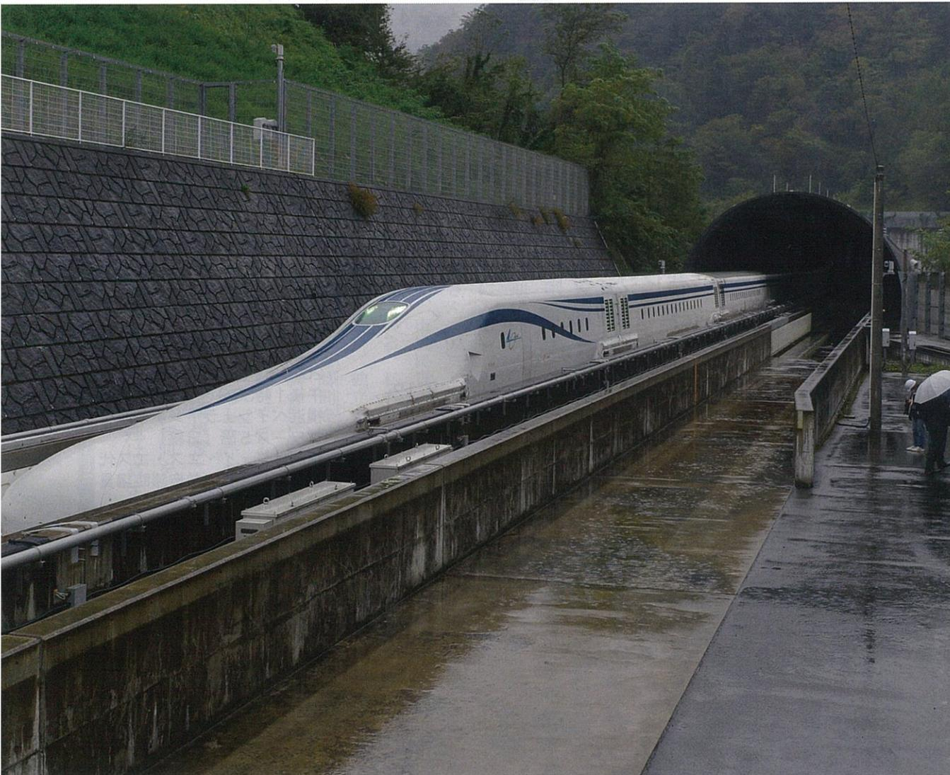
JR東海は10月19日、リニア中央新幹線の改良型試験車の試乗会を行い、車内を初公開した。空気抵抗を減らすために先頭車を改良した。
